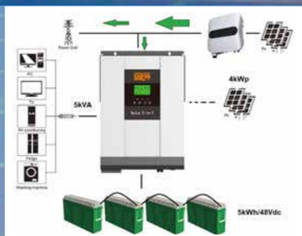
Hierbij een voorbeeld van een 5kVA met bestaande zonnepanelen en omvormer
